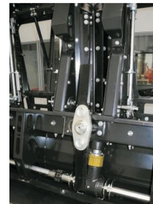
Sur les côtés : les tringles de rappel des fameuses plaques à réglage automatique.
